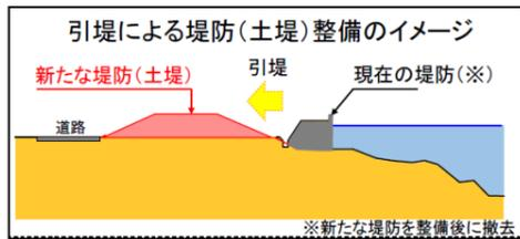
引堤については、大橋周辺の最上川の形状が横山側にカーブしているため、横山側に堤防を引いてカーブを緩和し、川の断面積を拡げて洪水時の水位を低下させます。
